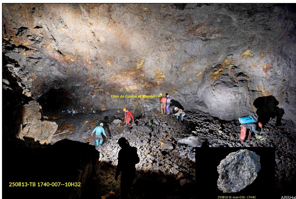
Figure 75 PLAN SAINT JEAN : chambre d'exploitation sur faille majeure, zones oxydées
